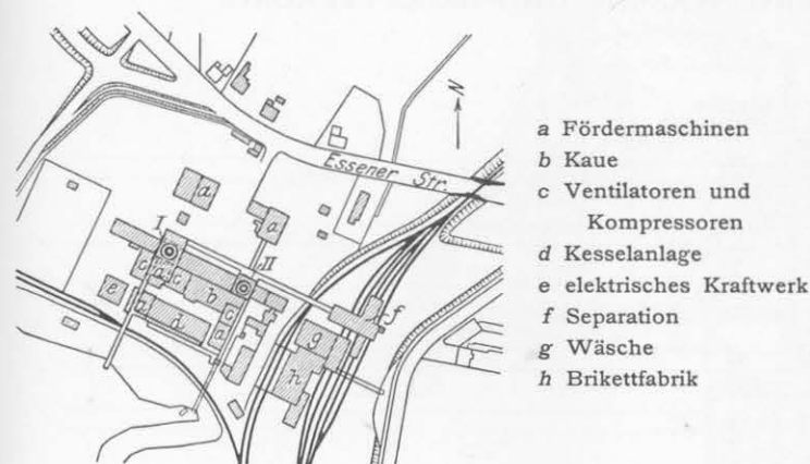
Figur 9, Zeche Oberhausen: Lageplan der Tagesanlagen.
